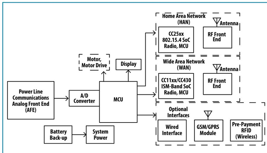
Figure 1. Smart Meter Block Diagram
